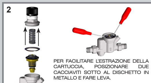
2- Estrarre la molla e la cartuccia. Eseguire la pulizia ed eventualmente sostituire la cartuccia nel caso si fosse danneggiata.
